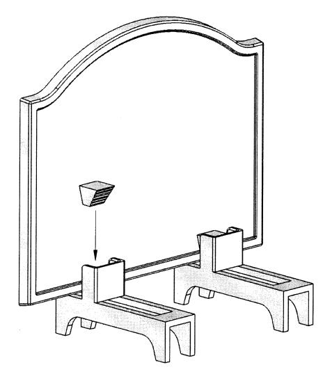
PLACE THE FIREBACK ON THE FEET. INSERT WEDGE WITH TEXTURED SIDE AGAINST FOOT AND BLANK SIDE AGAINST THE FIREBACK. SLIDE THE WEDGE DOWN TO SECURE THE FIREBACK (TAP IT IN IF NEEDED)
