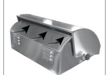
YOU MUST PROTECT REAR OVEN **VENT FROM PREVAILING WIND** Fig. 3-1
