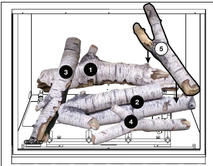
5. Placez le côté inférieur droit de la bûche n°4 sur le poteau de la grille n°4 sous la bûche n°2. Assurez-vous que la bûche s'engage avec le support de localisation. Appuyez l'extrémité en "Y" entre les poteaux de la grille n°2 et n°3, et engagez-la avec la barre principale.
