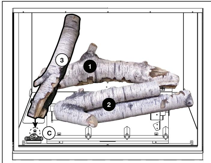
3. Placez l'encoche sur le "Y" de la bûche n°2 sur le poteau de la grille n°2, en reposant l'extrémité opposée sur le support de localisation. Assurez-vous que la bûche ne recouvre aucun des ports du brûleur.
