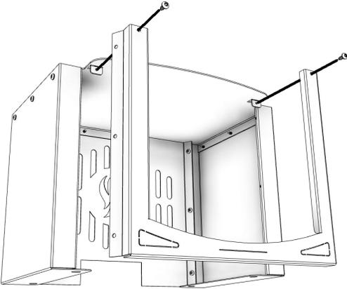
5. Fixez le panneau avant du piédestal aux panneaux latéraux gauche et droit du piédestal à l'aide d'un total de six (6) vis n° 10, comme illustré. REMARQUE : le panneau arrière du socle a été retiré de cette image uniquement à des fins de clarté. Ne retirez pas le panneau arrière du piédestal lors de l'installation du panneau avant du piédestal.
