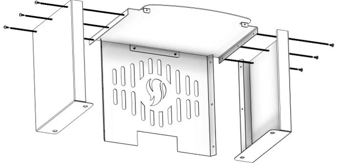
3. Fixez les panneaux latéraux gauche et droit du piédestal à l'arrière du piédestal à l'aide d'un total de six (6) vis n° 10, comme illustré.
