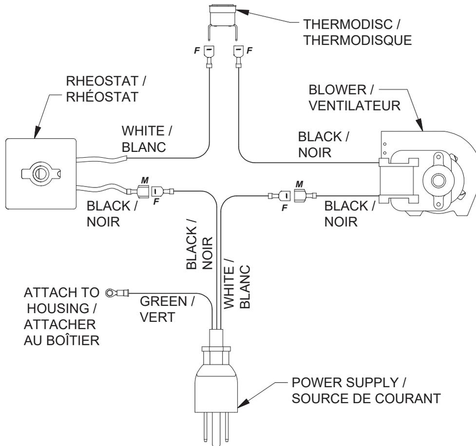
**NOTICE: DO NOT ALLOW THE POWER CORD TO TOUCH HOT SURFACES! KEEP THE POWER CORD AT LEAST 12"/30.5CM FROM THE STOVE OR PIPE SURFACES.**
