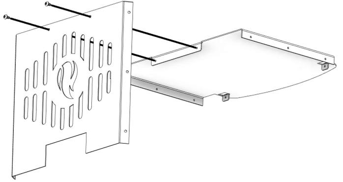
2. Fixez les panneaux latéraux gauche et droit du piédestal à la base du piédestal à l'aide d'un total de six (6) vis n° 10.
