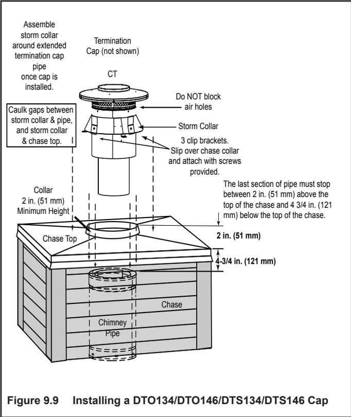
**Figure 9.9** Installing a DTO134/DTO146/DTS134/DTS146 Cap
