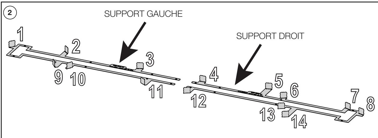
Une fois séparées, plier les 10 languettes de positionnement à 90° à l'aide d'une pince.
