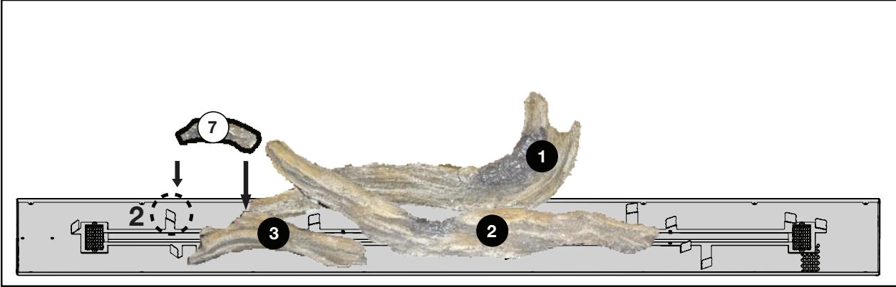
4. Placez l'extrémité carbonisée de la bûche n° 7 sur le côté droit de la languette n° 2. Veillez à ce que la bûche soit contre la languette. Posez l'extrémité opposée sur la bûche n° 3.
