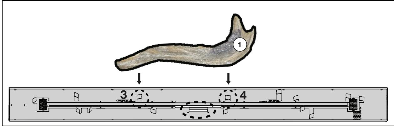
1. Placer la bûche n° 1 derrière les languettes de positionnement n° 3 et 4. S'assurer que la bûche est contre les languettes.
