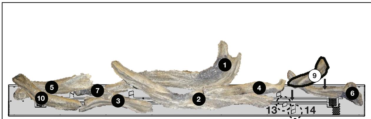
9. Placez l'extrémité pointue de la bûche n° 9 entre les languettes de positionnement n° 13 et 14 et posez l'extrémité opposée sur la bûche n° 6. Veillez à ce que la face carbonisée soit orientée vers le brûleur.
