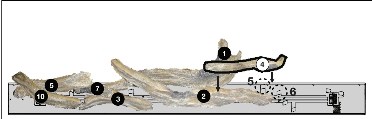
7. Avec l'extrémité carbonisée sur le plateau, placez la bûche n° 4 entre les onglets n° 5 et n° 6. Placer l'extrémité opposée dans la rainure de positionnement de la bûche n° 2.
