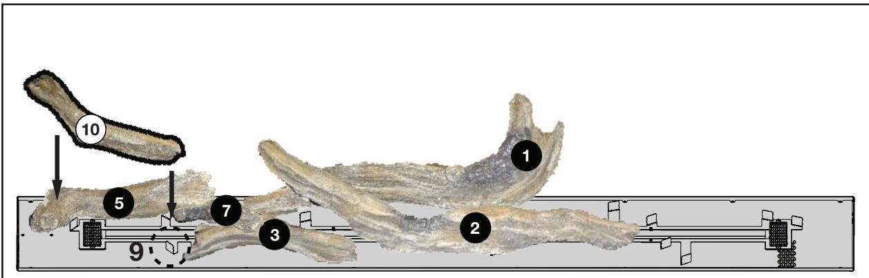
6. La face carbonisée étant tournée vers le brûleur, placez l'extrémité pointue de la bûche n° 10 sur le plateau devant la languette n° 9. Veillez à ce que la bûche soit contre la languette. Posez l'extrémité opposée sur la bûche n° 5.
