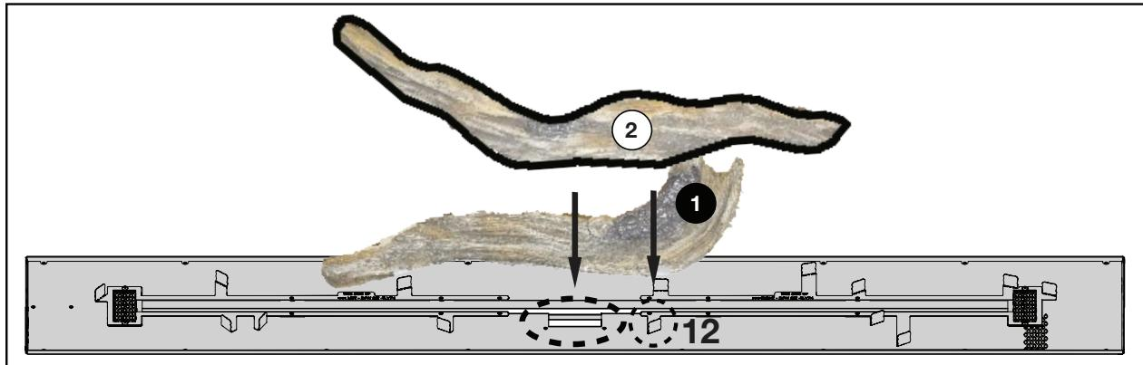
2. Placez la bûche n° 2 devant la languette de positionnement n° 12 et la veilleuse. Veillez à ce que la bûche soit contre la languette et la veilleuse.
