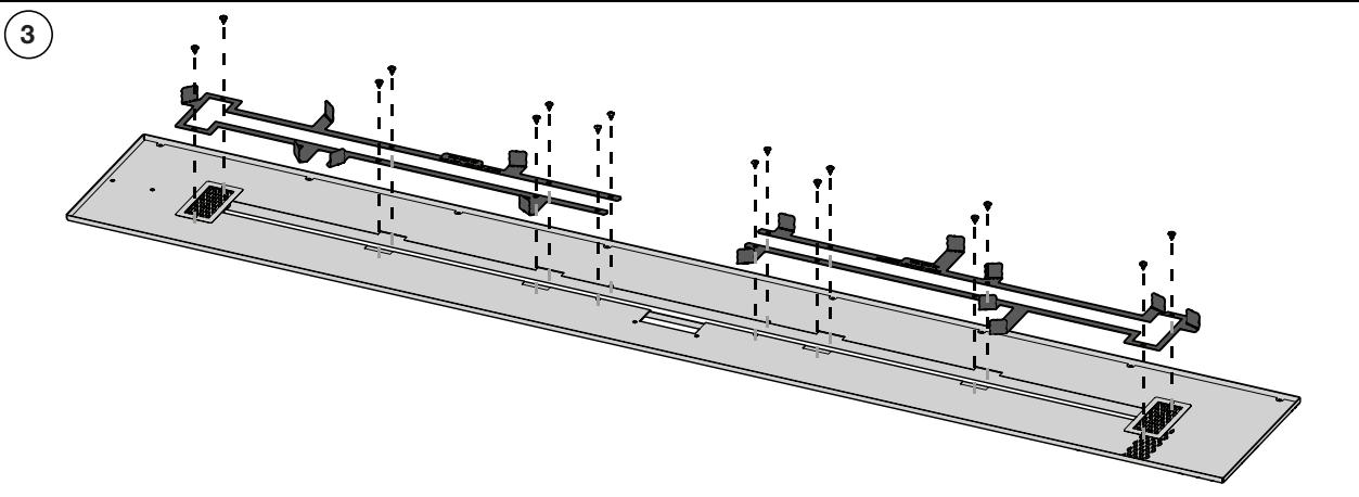
Commencez par le côté gauche de l'appareil. Retirez les 8 vis du plateau et du brûleur. Placez le support gauche sur le plateau et le brûleur en le fixant à l'aide des vis qui viennent d'être retirées. Répétez l'opération pour le côté droit.
