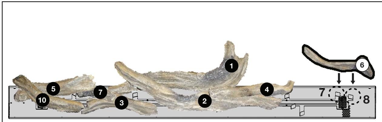
8. Placer la bûche n° 6 devant les languettes de positionnement n° 7 et 8. S'assurer que la bûche est contre les languettes.
