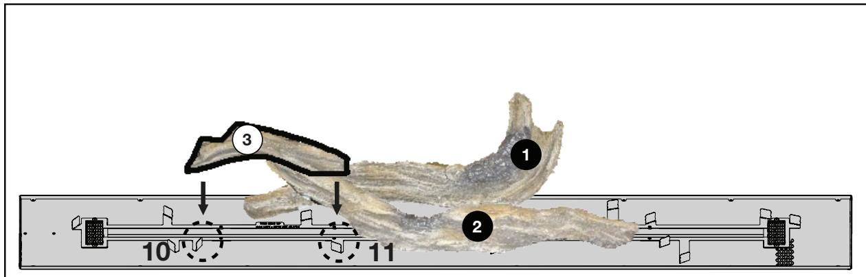
3. Avec l'extrémité carbonisée tournée vers le brûleur, placez la bûche n° 3 devant les languettes de positionnement n° 10 et 11. Veillez à ce que la bûche soit contre les languettes.
