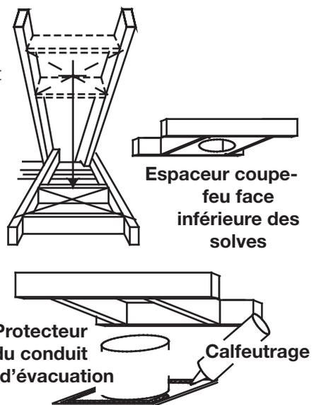
Une fois que le conduit d'évacuation est en place, appliquez un scellant silicone rouge (W573-0002) (non fourni) entre le conduit d'évacuation et l'espaceur coupe-feu.
