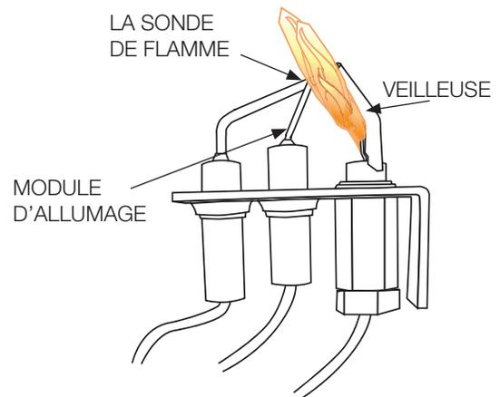
LA FLAMME DOIT ENVELOPPER LA PARTIE SUPÉRIEURE DE LA SONDE DE FLAMME DE 3/8 po (9,5MM) À 1/2 po (12,7MM)
