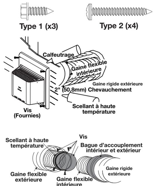
**Les terminaisons ne doivent pas être enchâssées dans un mur ou un revêtement extérieur plus que l'épaisseur de la bride de la plaque de montage.**
