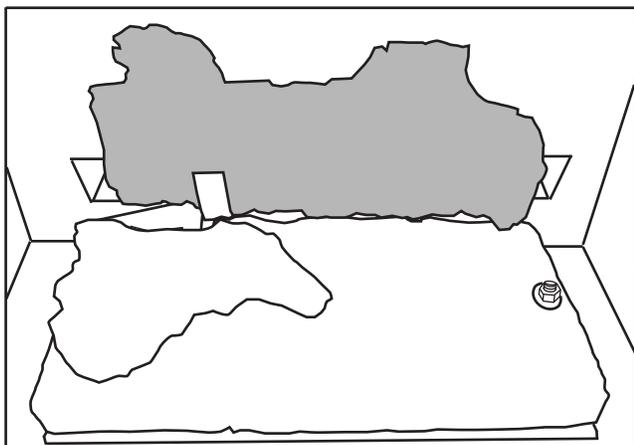
**B.** Placez le trou sous la bûche #2 sur la vis de positionnement, du côté gauche du brûleur. Le brûleur en fibre est formé de façon à épouser la partie centrale de la bûche.
