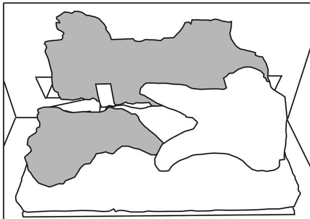
**C.** Placez le trou sous la bûche #3 sur la vis de positionnement, du côté droit du brûleur. La branche inférieure de la bûche #3 est placée devant et contre l'extrémité droite de la bûche #2.
