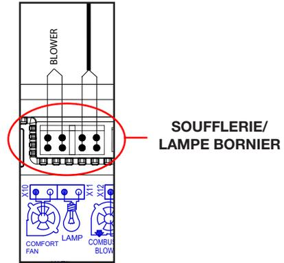
1. Débrancher le bornier du soufflerie / lampe.
