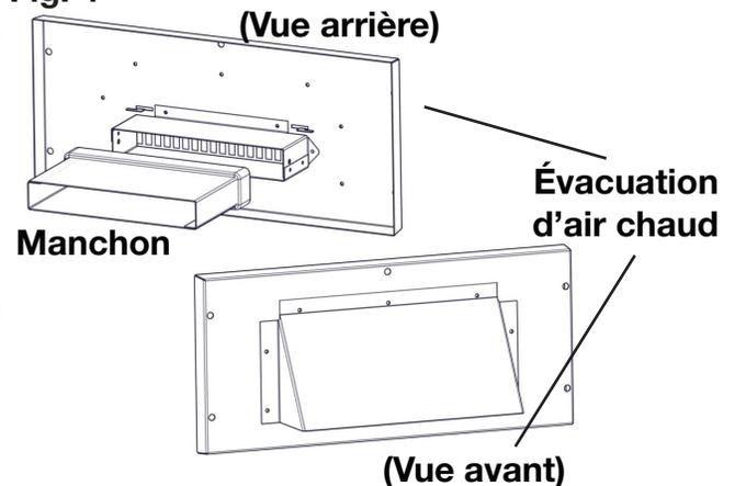
Rendez étanche en scellant avec du calfeutrage non fourni. Des ancrages peuvent être nécessaires pour visser les vis.
