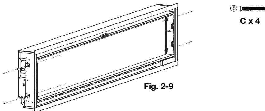
9. Utilisez 4 vis (fournies) afin de fixer l'appareil au mur (**Fig. 2-9**). Ne pas trop serrez les vis.
