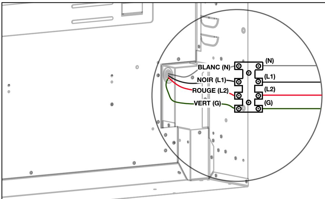
1. Retirez les vis de fixation de la plaque de recouvrement de la boîte de jonction, située sur le côté gauche, à l'arrière de l'appareil. Jetez la plaque de recouvrement de la boîte de jonction et mettez de côté les vis.
