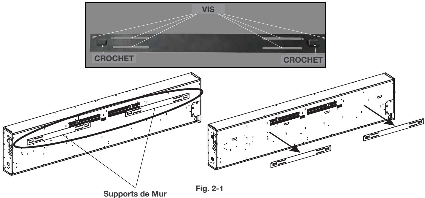
4. Marquez l'emplacement, puis montez le(s) support(s) sur le mur en utilisant les vis (fournies). Ce support doit avoir les crochets vers le haut et être au niveau.
