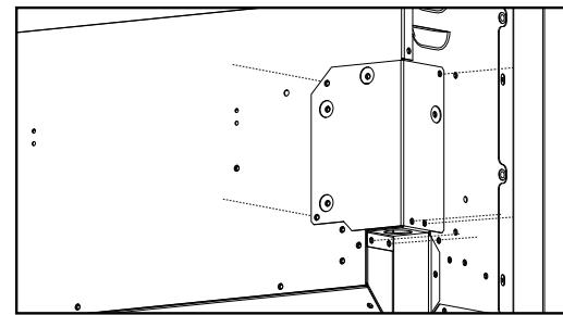
Avant de câbler l'appareil, retirez le couvercle de commande de la boîte de jonction en retirant les vis comme indiqué.
