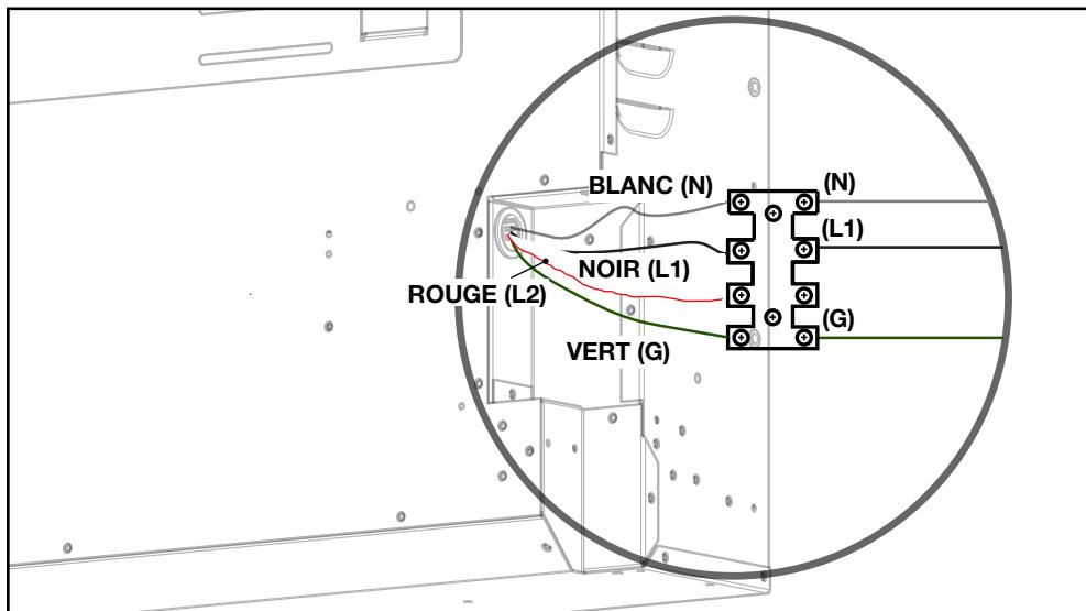
1. Retirez les vis de fixation de la plaque de recouvrement de la boîte de jonction, située sur le côté gauche, à l'arrière de l'appareil. Jetez la plaque de recouvrement de la boîte de jonction et mettez de côté les vis.
