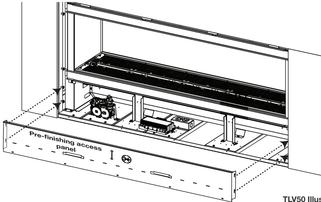
Avant de terminer dans l'appareil, testez l'opération à l'aide de la télécommande, faites-le passer à travers tous ses différents modes, voir la section "opération" dans le manuel du propriétaire. Une fois terminé, l'accès aux composants de commande ne peut être effectué que par l'intérieur de l'appareil.
