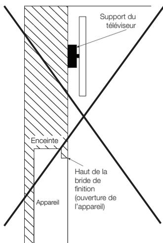
Installation partiellement enchâssées avec un manteau
