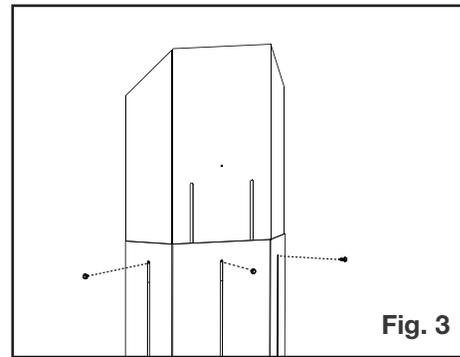
3. Utilisez les attaches à l'étape 1 pour maintenir la nouvelle hauteur de bouclage d'évent (Figure 3).
