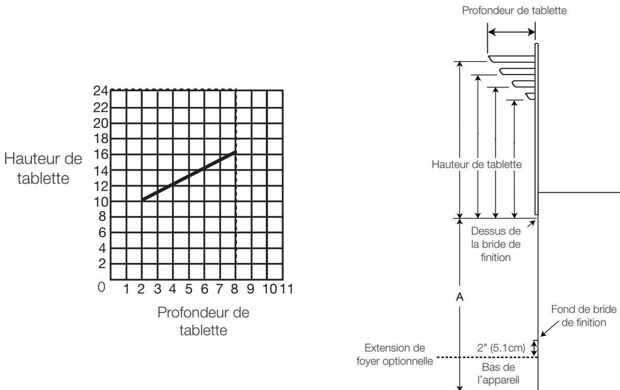
L'installation d'un manteau entre cet appareil et l'électronique ou d'autres matériaux susceptibles d'être sensibles à la chaleur réduira l'effet de la chaleur directe sur ceux-ci. Assurez-vous que le châssis est correctement dimensionné (largeur et profondeur) en fonction de l'objet monté ci-dessus. Suivez les instructions de hauteur et de profondeur du manteau pour obtenir des informations appropriées.
