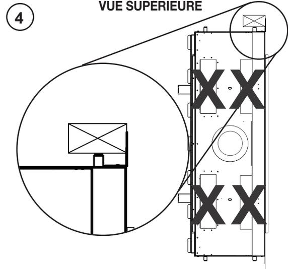
Pour installer les pattes de cloutage pour les appareils de voir à travers, répétez ces étapes sur l'autre côté.
