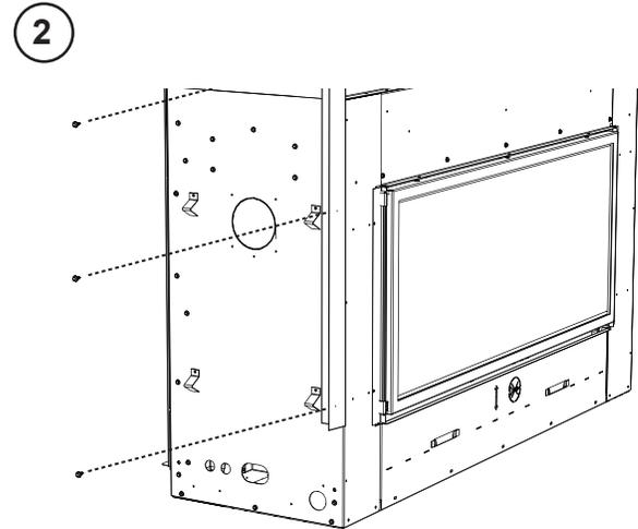
Alignez les pattes de cloutage avec les trous de l'appareil, fixez avec les deux vis d'étape 1.
