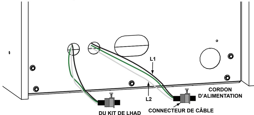
Approchez l'alimentation électrique et le kit LHAD en option à travers le foyer extérieur sur la prise montée au bas de l'appareil. Pour l'installation du kit LHAD en option, reportez-vous à la notice fournie dans le kit.
