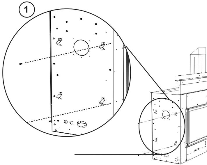
Retirer les deux vis de l'appareil.
