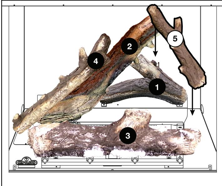
5. Placez le trou de localisation dans la bûche n°4 sur l'élément de localisation sur la bûche n°2. Posez l'extrémité opposée dans le rond sur le côté droit de la bûche n°3.
