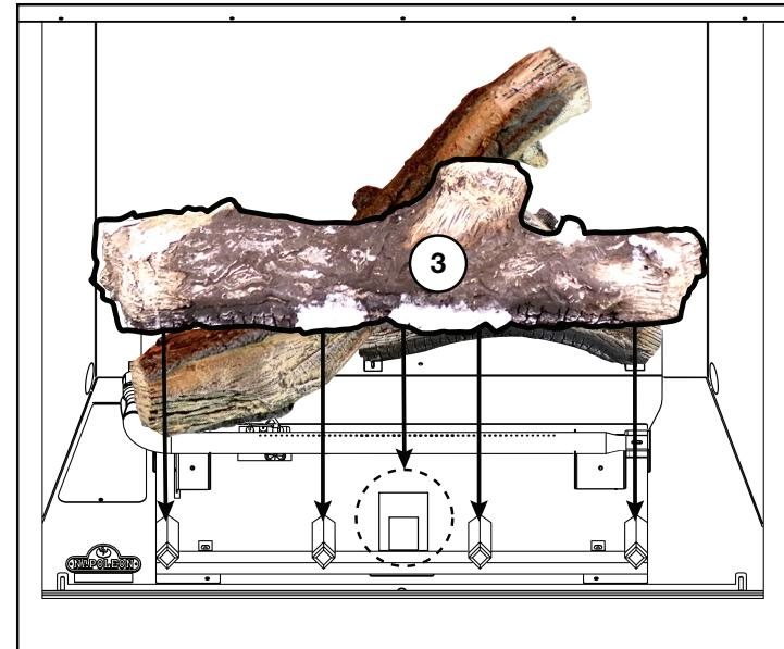
3. Placez le fond rond de la bûche n°2 sur le coin du brûleur, en vous assurant que le noeud de repérage s'insère dans le trou sur le dessus de la bûche n°1.
