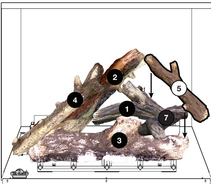
7. Placez le trou de localisation de la bûche n°7 sur le montant de localisation "D", en posant l'extrémité opposée sur le nœud de localisation sur le côté droit de la bûche n°3.
