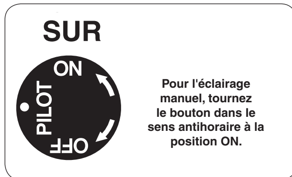
Fig. 28-1 Détail bouton de commande (SUR)
