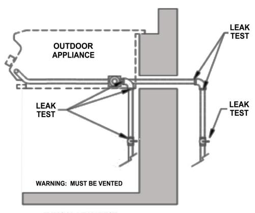
TYPICAL LEAK TEST
