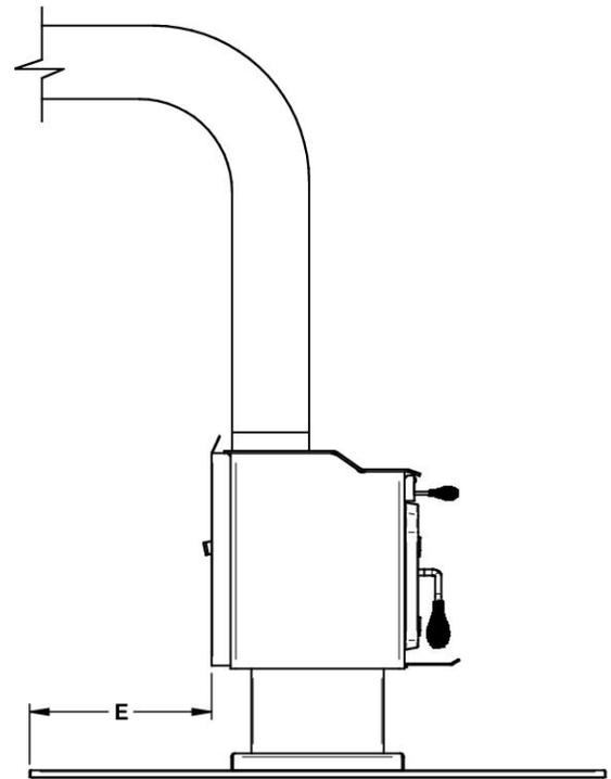
**Figure 2 : Side View - Floor Protection**
