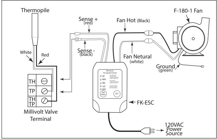
Fig. 2 Millivolt wiring diagram
