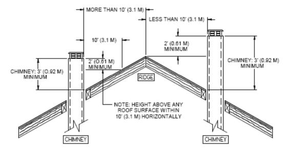
Figure 42 : Slope Roof
